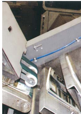
▲ Nach der Vereinzelnung erfolgt die Zuführung zum Klebebinder.
